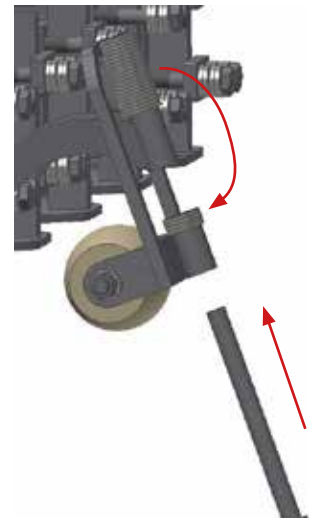
Fig. 28. Adjust the washers
